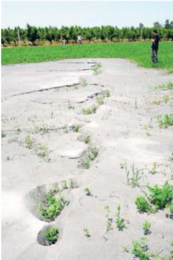
Frattura di 15 m con massiva estrusione di sabbie grigie a NE di Mirabello.
