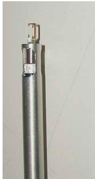
Fig. 2 - Particolare del sensore di misura dell'anemometro.
