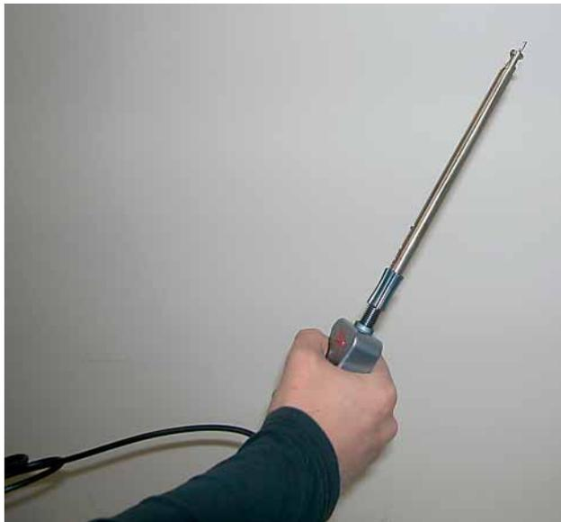
Fig. 1 - Anemometro a filo caldo.
