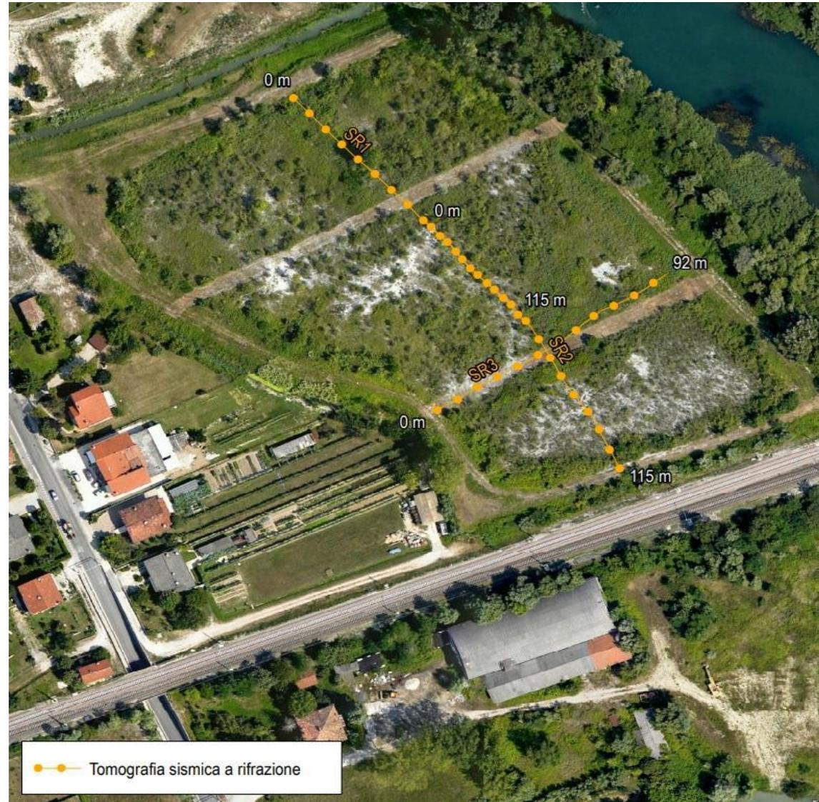
Le prospezioni sismiche condotte, elaborate in onde P, hanno permesso di distinguere livelli caratterizzati da diverso grado di addensamento, con un generale incremento delle caratteristiche meccaniche con la profondità. Sono stati discretizzati in particolare tre livelli con caratteristiche differenti in termini di grado di addensamento. In tutte e tre le prospezioni sismiche effettuate si rinviene :
