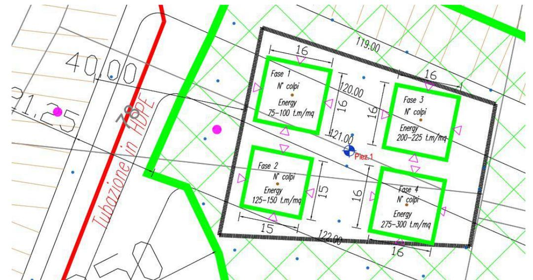
La sperimentazione nelle celle ha riguardato sia gli effetti dinamici delle onde d'urto generate dalla caduta dei gravi sulle strutture di contenimento della discarica, definendo se il fenomeno fosse avvertito anche al di fuori della stessa, che le mutazioni fisiche dello stato della massa dei rifiuti.
