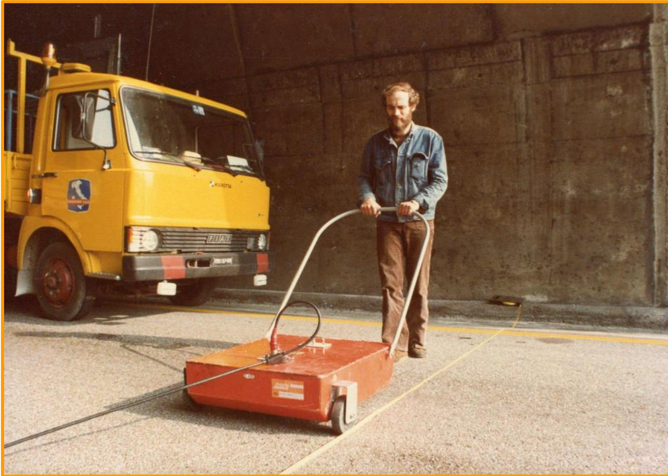
Rilievo georadar sulla pavimentazione della galleria
