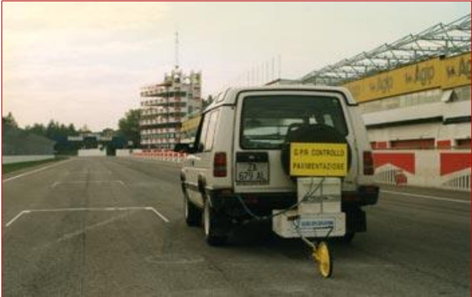
Acquisizioni dati con antenne da 2.5 GHz
