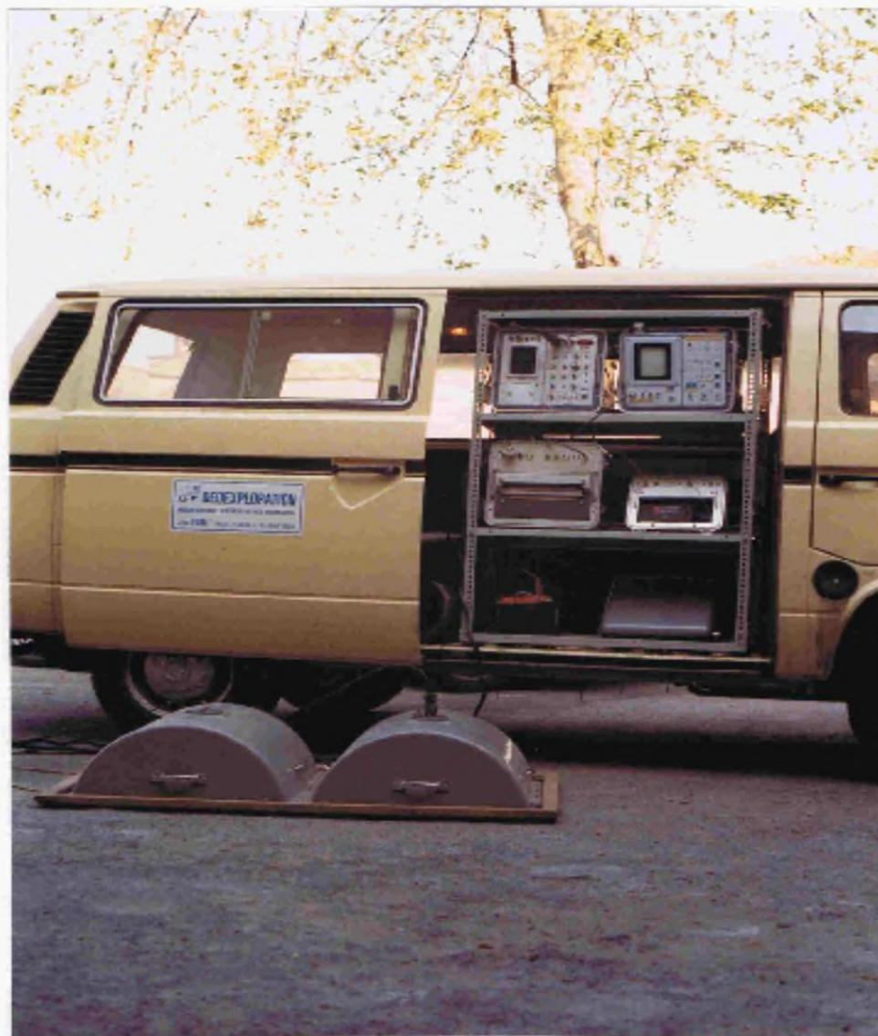
Figura 5.3 - Strumentazione Georadar OYO con antenne da 120 MHz.
