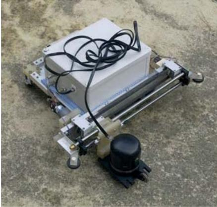
Fig. 18 - Prima versione prototipale di sistema robotizzato per acquisizione olografica del suolo controllato in remoto.
